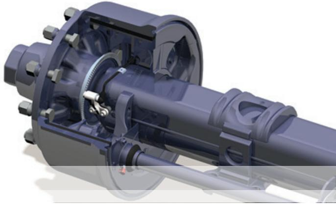
Planlaufgenaues auf die Nabe aufgedrehtes Polrad. Höhere ABS Funktions-sicherheit, dank Sensorpositionierung in biegeneutraler Achsmitte, keine Lüftspieländerungen bei wechselnden Achsbelastungen.
